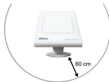
Fig. 1 Sotto, frontalmente e lateralmente, il dispositivo deve essere distante da altri elementi (elementi e parti costruttive, ecc.) almeno 60 cm.
