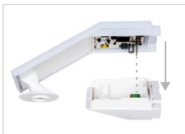
Fig. 14 Mettere il coperchio sul fondo. Si avrà l'inse- rimento della scheda del coperchio nel con- nettore femmina del fondo.
