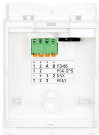
Fig. 13 Collegare il raccoglitore di dati/tensione P03/ P04 (+24 V DC/GND) ai morsetti 1/2 P04i-GPS.
