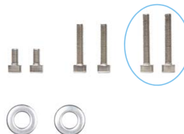
Abb. 7 Utilisez pour le montage les vis à tête cylindrique DIN 912 M4x25 et posez les rondelles DIN 125 sous les têtes de vis.
