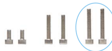
Abb. 5 Utilisez pour le montage les vis à tête cylindrique DIN 912 M4x25 et posez les rondelles DIN 125 sous les têtes de vis.
