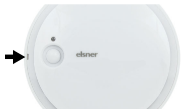
Fig. 3 Abra la carcasa. Levante cuidadosamente la cubierta de la base. Apalanque desde la hendidura (fig. 2: A).
