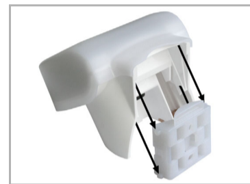
Fig. 14 Deslice el gabinete desde arriba en el soporte montado. Las espigas del soporte deben engatillarse en los rieles del gabinete.
