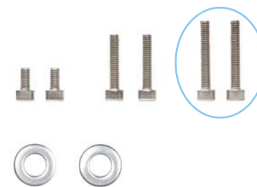
Abb. 9 Para el montaje, utilice los tornillos de cabeza cilíndrica DIN 912 M4x25 y coloque las arandelas DIN 125 debajo de las cabezas de los tornillos.
