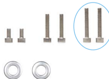
Abb. 7 Para el montaje, utilice los tornillos de cabeza cilíndrica DIN 912 M4x25 y coloque las arandelas DIN 125 debajo de las cabezas de los tornillos.
