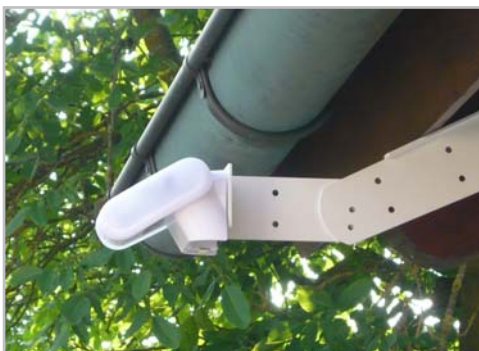
Abb. 1: Durch den Gelenk-Ausleger schaut die Wetterstation unter dem Dachvorsprung hervor. Sonne, Wind und Niederschlag können ungehindert auf die Sensoren einwirken.
