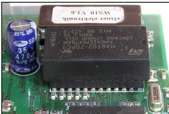
Abb. 4: Die Anschlüsse müssen fest im Sockel stecken
