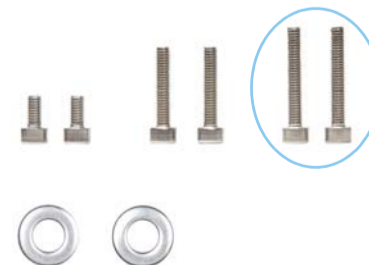
Abb. 7 Verwenden Sie zum Montieren die Zylinderschrauben DIN 912 M4x25 und legen Sie die Scheiben DIN 125 unter die Schrauben-Köpfe.
