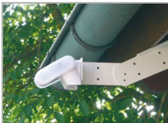
Abb. 6 Beispiel für den Einsatz des Gelenk-Auslegers: Durch den Gelenk-Ausleger ragt die Wetterstation unter dem Dachvorsprung hervor. Sonne, Wind und Niederschlag können ungehindert auf die Sensoren einwirken.
