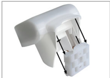
Abb. 13 Schieben Sie das Gehäuse von oben in den montierten Halter. Die Zapfen des Halters müssen dabei in den Schienen des Gehäuses einrasten.
