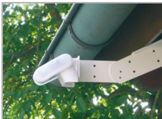
Abb. 7 Beispiel für den Einsatz des Gelenk-Auslegers: Durch den Gelenk-Ausleger ragt der Sensor unter dem Dachvorsprung hervor. Sonne kann ungehindert auf die Sensoren einwirken.
