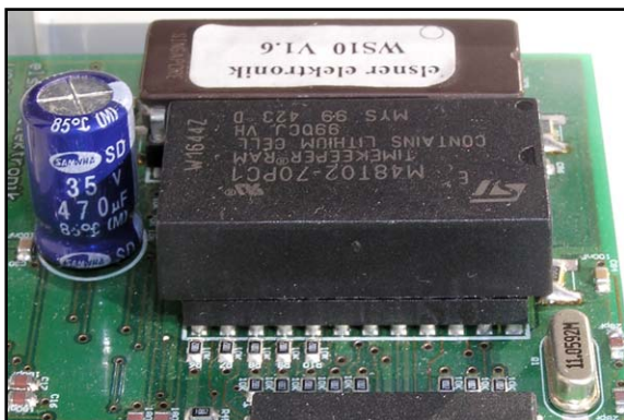
Abb. 4: Die Anschlüsse müssen fest im Sockel stecken
