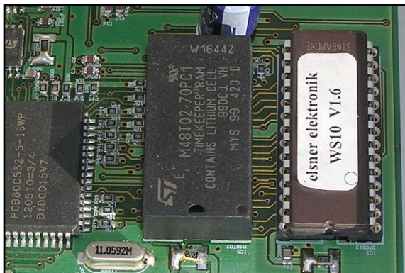
Abb. 3: S-Ram-Batterie in der Steuerung WS10
